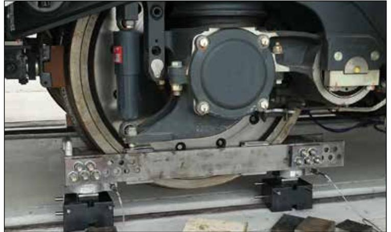
A grande variedade de recursos de instrumentação da ENSCO inclui Rodeiros Instrumentados (topo), novos testes de aceitação de veículos (esquerda) e testes estáticos (direita).
